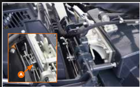
Frontheber mit Schnellbefestigung mit Sicherheitshebel (A)
