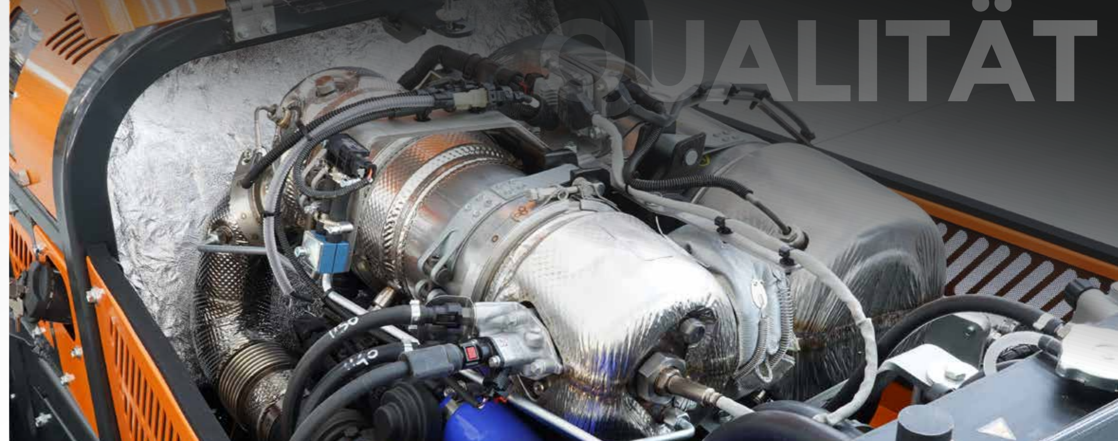
DEUTZ-MOTOR 100 PS, ABGASSTUFE V
