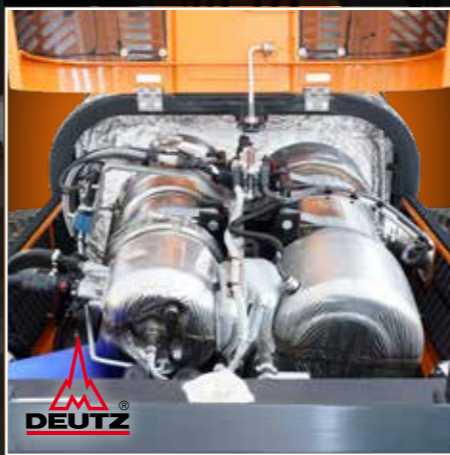
DEUTZ-MOTOR 100 PS, ABGASSTUFE V
